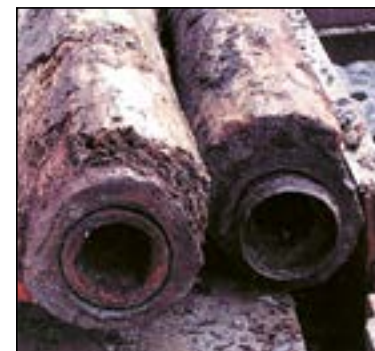
Uthulte furustammer ble brukt som vannrør i Kristiania i 200 år. Rørene var forbundet med jernskjøter. Foto fra boken.
